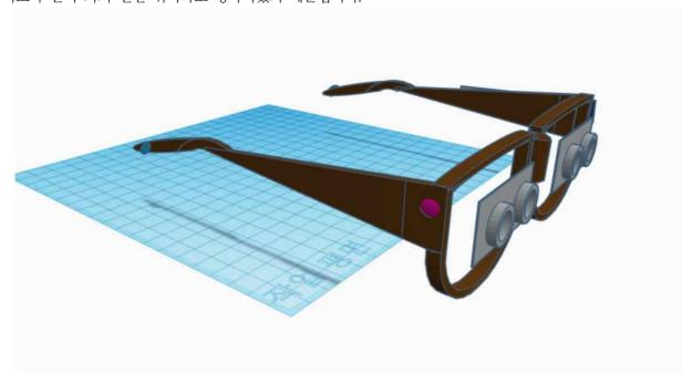
추가로, 본 설계는 초음파센서에서 감지한 정보를 안경에 부착되어 있는 모터로 연동하며 작동합니다. 특히, 일정거리 내에서 장애물이 발견되었을 때 모터가 작동하여 위급상황에서 시각장애인에게 즉각적인 경보를 줄수 있다는 장점이 있습니다. 하지만 모터가 작동할 기준 거리 설정의 모호함과 오차로 인한 모터 작동에서의 문제를 발견할 수 있었습니다. 최초 가제품 제작 시에는 0.5m 이내에서 장애물이 발견되었을 때 모터가 작동하도록 하였는데, 실제로 보도에 위험이 되지 않는 물체까지 모터가 작동하여 착용자가 불편함을 느꼈습니다. 하지만 이는 모터나 센서 부착등의 설계 내용의 본질적인 문제가 아니므로 보다 세밀한 모터 작용 조건 설정과 수차례의 실험으로 해결할 수 있을 것으로 기대됩니다.
