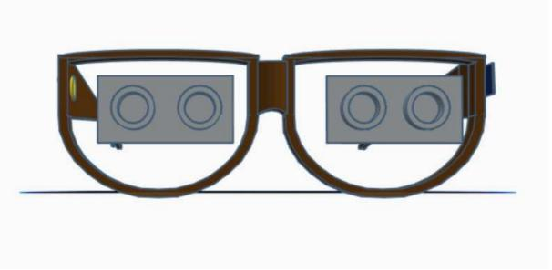
우선 가장 부피를 많이 차지하는 초음파센서의 위치를 과감하게 전면부에 배치하였습니다. 그리고 이를 어느정도 미적인 요소로 승화시킬 계획입니다. 기존의 안경 형태에 너무 집착하는 것 보다 오히려 "안경알 없는 안경"이라는 과감한 모토를 차용하는 것으로 방향을 잡았습니다. 보드와 배터리는, 안경 다리에 붙어 있으며, 보드에 관한 정보는 위에 기술하였으며 배터리의 경우 3.3v 전용 리튬폴리머 배터리를 사용하였습니다. 배터리의 크기는 보드와 흡사한 크기로 결정하였습니다. 그 다음으로, 사람이 보통 안경을 썼을 때, 안면과 가장 접점이 많은 부위는 안경다리 끝 쪽이라는 것을 파악하고, 진동 모터의 위치를 안경 다리 끝 쪽에 닿게 하여 사용자가 진동을 최대한 잘 느낄 수 있도록 하였습니다. 버튼은 관자놀이 정도의 위치에 부착하였습니다. 아무래도 다른 위
