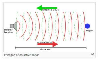
위 사진과 같이, 초음파를 발사하고, 초음파가 물체에 다시 반사되어 되돌아오면 이를 감지하고 받아들입니다. 또한, 그 동안의 시간을 측정하여 거리를 측정합니다. 거리를 측정하기 위한 파라미터들은 다음과 같습니다. 대상 물체까지의 거리: L [m]
