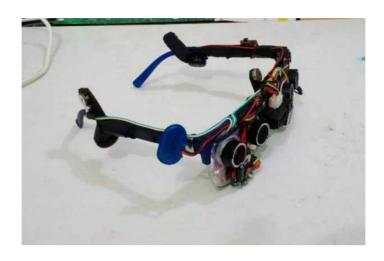
3D 프린터로 내부 안경 골격을 프린트하였으며, 그 위에 앞의 설계 내용에서 기술한 대로 모듈들을 부착했습니다. 몇 가지 달라진 점에 대해 말씀드리자면, 먼저 착용 결과 안경 다리 끝 쪽에 진동 모터를 다는 것 만으로는 진동을 느끼기가 쉽지 않다고 판단하여, 안경 다리 쪽에 추가로 다른 뼈대를 더 프린트하여 기계장치를 착용하면 귀 위쪽에서 진동이 느껴지게 제작하였습니다. 또한, 부착 결과 아두이노 보드나 배터리, 블루투스 모듈같은 큰 부피를 차지하는 부품들을 안경 다리에 부착하면 착용감이 편하지 않고, 안경 다리에 무게가 많이 쏠려파손의 위험이 있었으므로 이를 초음파센서 뒤에 부착하여 안경알 부위에 위치하는 것으로 결정하였습니다.
