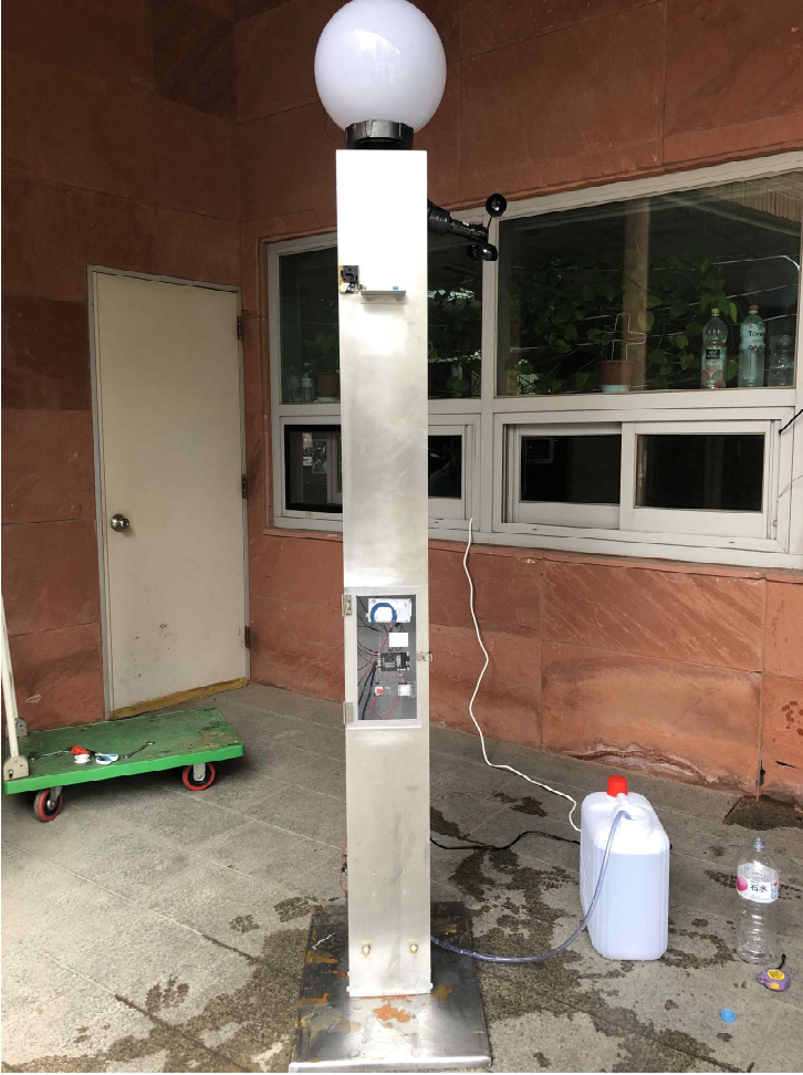
Fig 14. 완성된 모습 좌, 우측 각각 고무호스-신주-관-노즐 순으로 연결하였다. 각 연결부에는 호스밴드, 테프론 테이프를 사용하여 물이 새지 않게 설치하였다.
