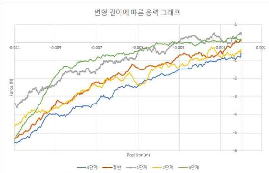
그림 8 변형 길이에 따른 응력 그래프 (mm-N)
