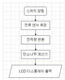
그림 19 나무 그루 변환 작동원리 그림 20 LCD 디스플레이 전체 모습
