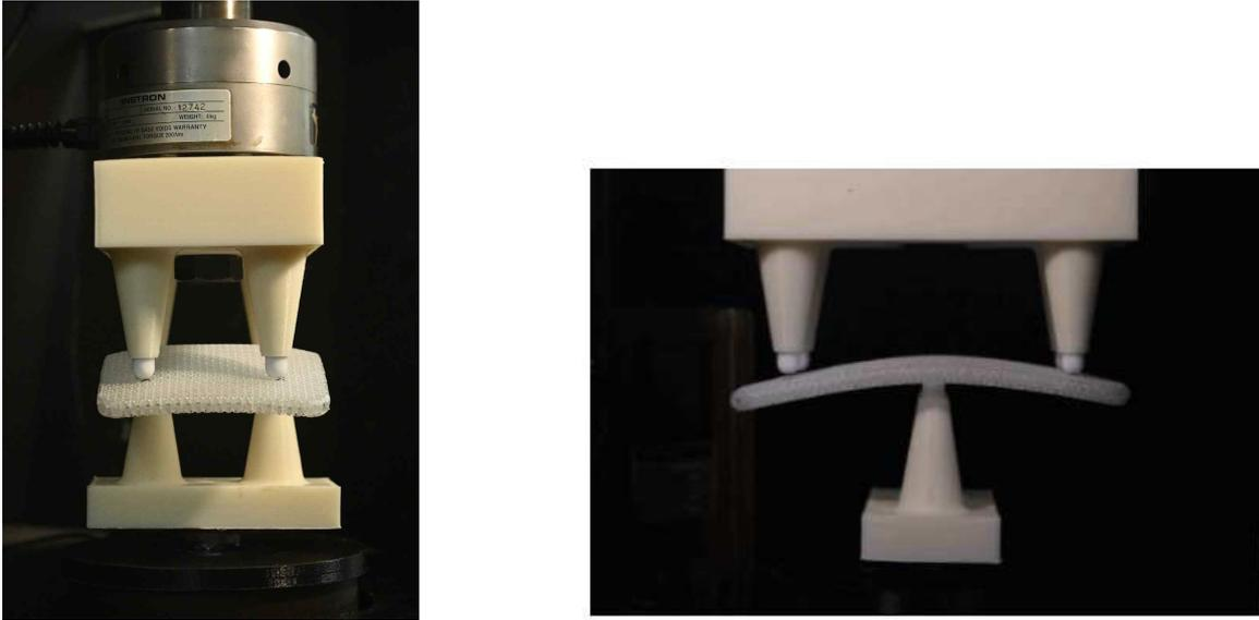
Figure18. Two-piece sandwich panel의 6-point bending 측면과 정면 모습 비교
